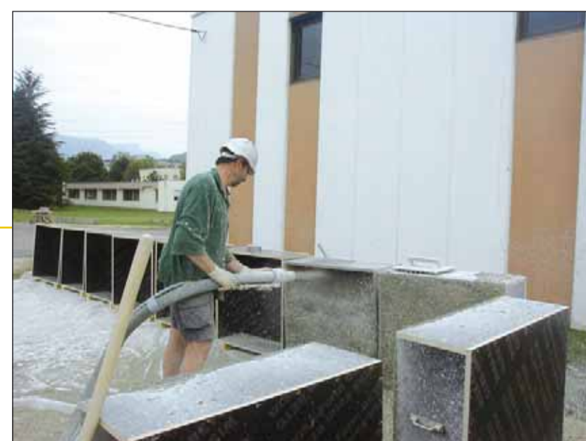
Fabrication d'éprouvettes de tailles représentatives des conditions de terrain pour le test des murs en béton de chanvre.
