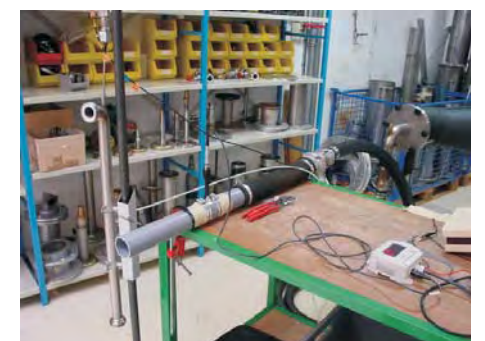
Étalonnage du débitmètre au CETIAT
