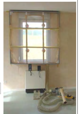
Schéma et photo du premier prototype de mesure de perméabilité à l'air des menuiseries
