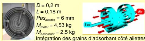
Prototype à faible ΔP en cours de réalisation
