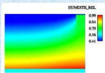
En revanche, l'utilisation d'un pare vapeur dit « intelligent », à perméabilité à la vapeur variable, permet de limiter les risques de condensation.
